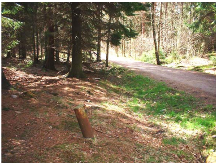
Figur 27. Undersökningsröret G2 i berg, ca 100 m djupt. Foto: A Fersters
